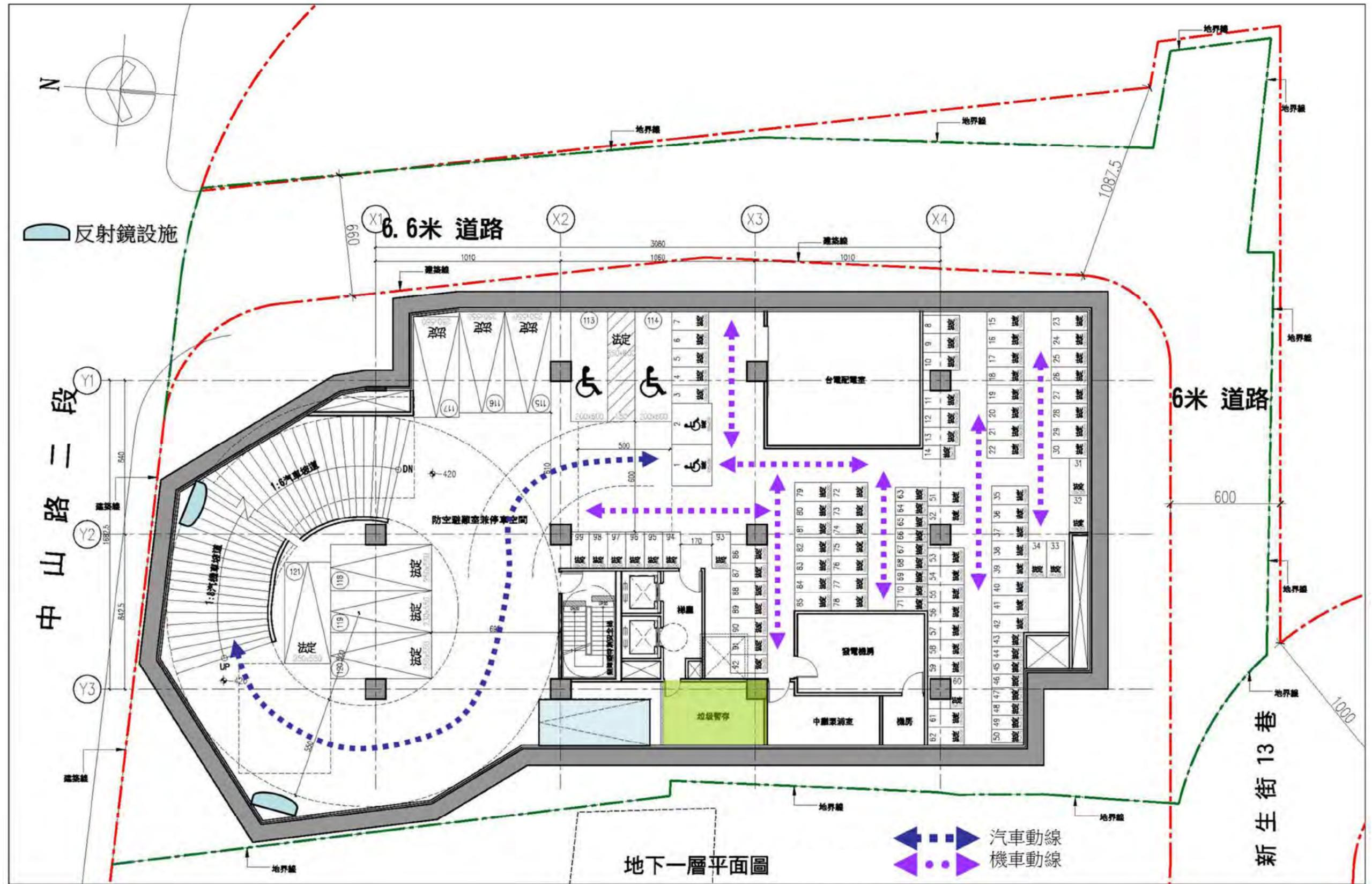
圖12-11、地下一層停車動線規劃示意圖
